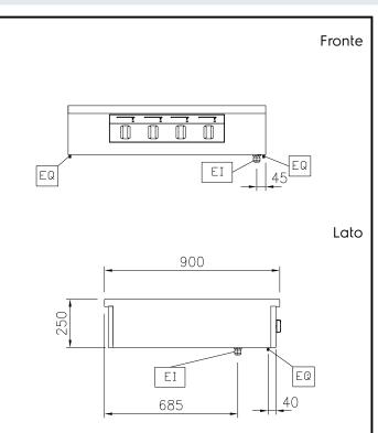
EI = Connessione elettrica EQ = Vite Equipotenziale
